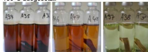
**Bild 4:** Alterungsuntersuchung von links nach rechts: nichtinhibiertes Öl, inhibiertes Öl, natürliches Ester. [4], [5]
