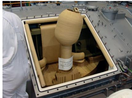
Abbildung 16: Feldformung im Bereich der HV-Ausleitung (HaPuflex550) im oberen Randfeld
