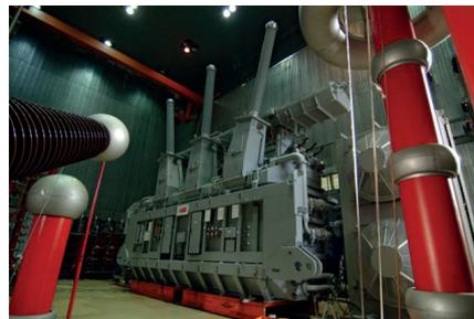
Abbildung 17: fertiger 250MVA-Regeltransformator mit  $U_m = 400\text{kV}$  im Prüffeld
