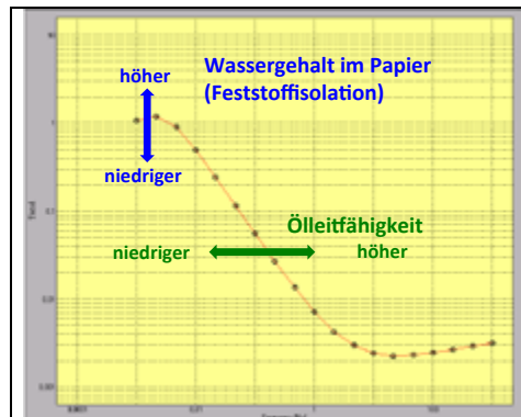
Bild 16: Einfluss der Ölleitfähigkeit und des Wassergehaltes in der Feststoffisolation auf den Verlustfaktor \tan \delta durch physikalische Vorgänge.
