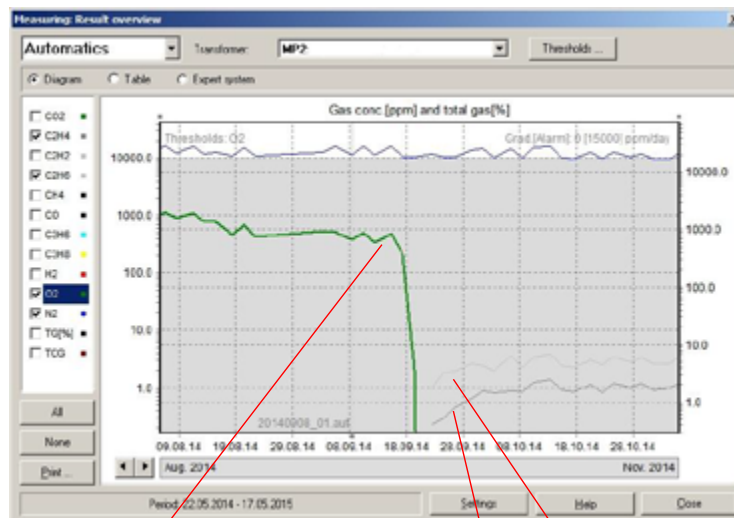
Starke Sauerstoffzehrung durch einsetzende akute Oxidationsprozesse mit beginnender Bildung von C 2 H 4 und C 2 H 6
