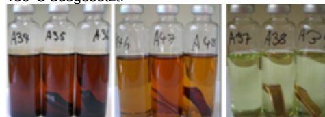
Bild 4: Alterungsuntersuchung von links nach rechts: nichtinhibiertes Öl, inhibiertes Öl, natürliches Ester. [4], [5]
