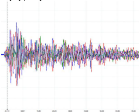
Bild 4: Beispiel von aufgenommenen OS- Spannungen 1u_u(t) /blau, 1u_v(t) /grün, 1u_w(t) /rot an diesem Dreiphasen- Ofentrafo.
