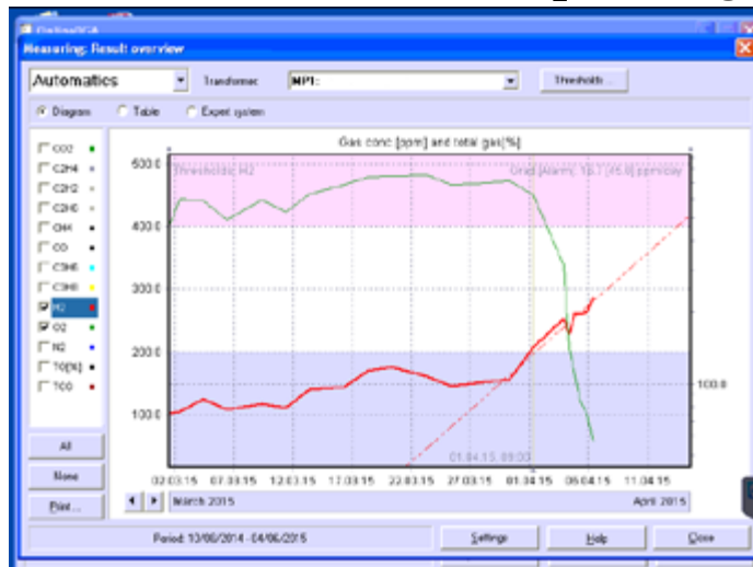
Einsetzende Oxidationsreaktionen unter Verbrauch von O 2 und zunehmender H 2 -Bildung
