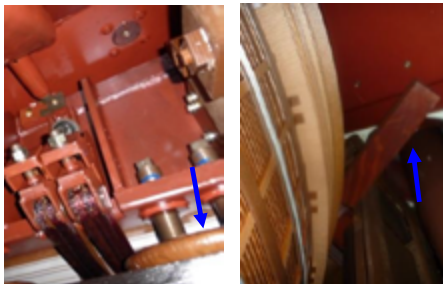
Bilder 11&12: Lockere Pressteller an Säule W und verschobenes Teil der Wicklungspressung.
