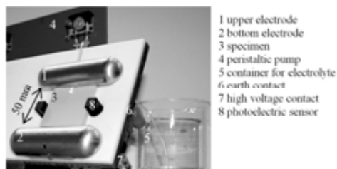
Bild 7: Abbildung der Anordnung des dynamischen Tropfenprüfverfahrens [4]
