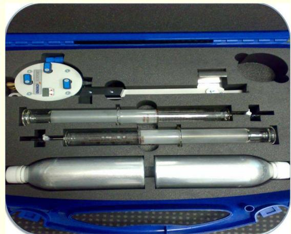
Ihr Ergebnis der Gas in Ölanalyse kann nur so gut sein wie Ihre Ölprobe gezogen wurde. Mit dem neuen Ölprobensystem der Firma Energy Support entnehmen sie die Ölprobe Kontaminationsfrei **ohne Aussenluft** mit automatischer Registrierung der Öltemperatur.
